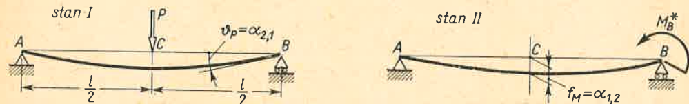
Rys. 9.46. Przykład zastosowania zasady wzajemności prac
